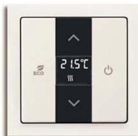
Abhängig von der Tageszeit und Funktion des Raumes. Im ECO-Betrieb wird die Temperatur automatisch bei Nacht oder Abwesenheit abgesenkt. Bei geöffnetem Fenster kann die Heizung automatisch abgeschaltet werden. So wird die Energiebilanz verbessert – ob bei herkömmlichen Heizkörpern oder Fußbodenheizungen.
